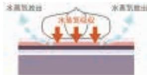
新素材「さらフェース」が水分の侵入を防ぎながら、身体とマットレスの間に発生する水蒸気(蒸れ)をカバー表面で吸収します。吸収した水蒸気は、身体が接触していない部分から放出します。蒸れを軽減することで、床ずれ要因の1つといわれる皮膚湿潤にも配慮、床ずれ防止と快適な就寝環境をサポートします。
