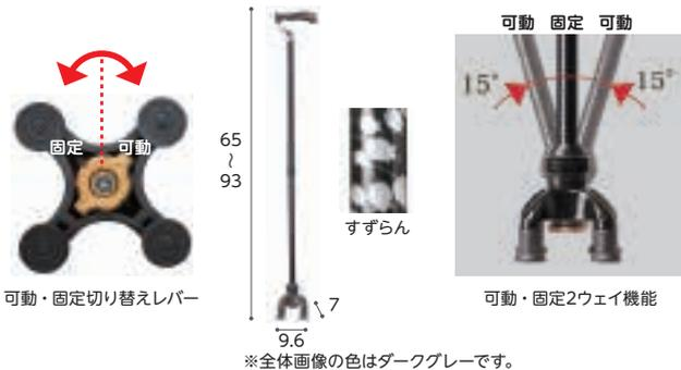
斜めに杖をついても前後に可動するので、地面に密着しながらより安定した歩行ができます。切り替えレバーで固定にすれば四点杖として使用可能。
