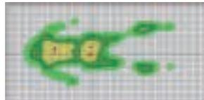
弾力性の異なるウレタンフォームを5層に合わせ、エクストラソフト面では静止型マットレス最高レベルの体圧分散性を発揮します。反対側のソフト面は反発性を高め、体圧分散性と動きやすさを両立しています。利用者様のADLなどの床ずれリスクに応じて使い分けことができます。エクストラソフト面の最上層は非常に柔らかく、体圧分散性の高さに加えて身体への当たりが心地よく優しく感じられるように配慮しています。
